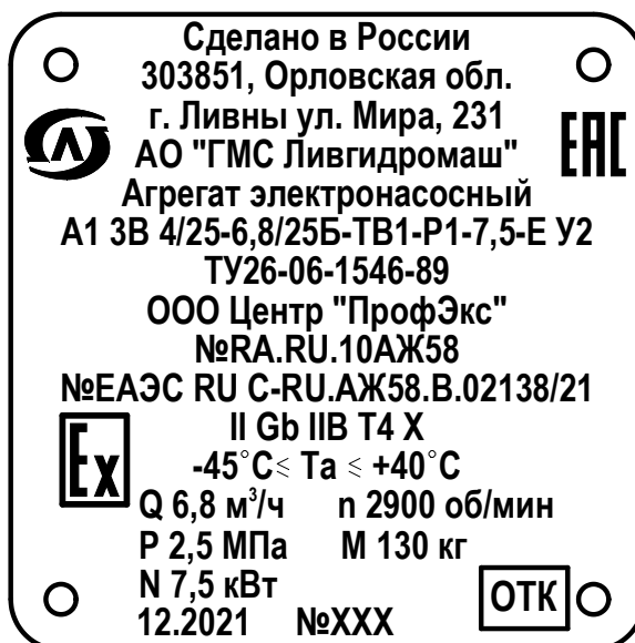
Рисунок 4 – Фирменная табличка (примеры оформления)
